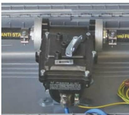
Gruppo portatile per travaso benzine, corredato di elettropompa a batteria con motore a 12 V a corrente continua.
